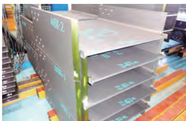
開先加工後の仕上がり
