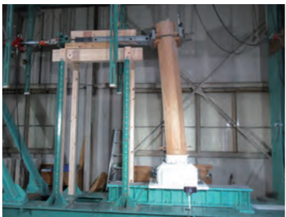
奈良県森林技術センターにて直径36cmの榎柱の実物大実験
